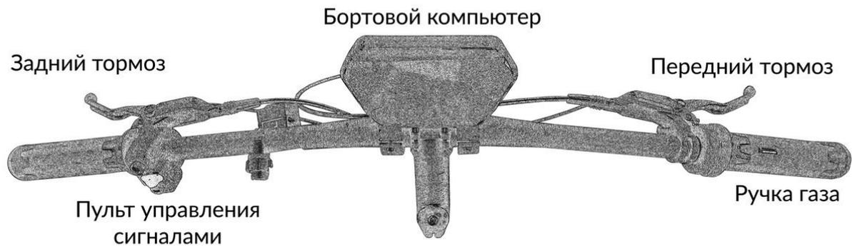
На руле расположены грипсы, ручка газа, ручки тормозов (переднего и заднего), бортовой компьютер, пульт управления сигналами.
